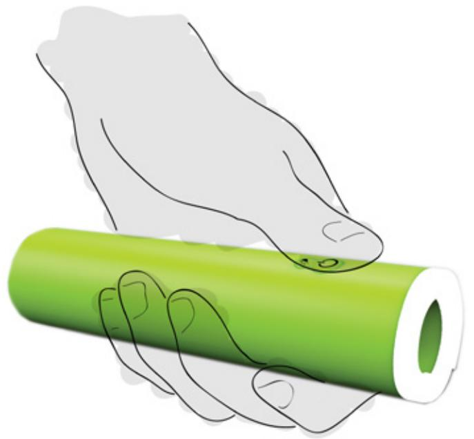
superficie es una celda fotovoltaica. El producto es totalmente flexible por lo que puede ser enrollado tomando la forma de una linterna cilíndrica convencional y ocupar menos espacio. Un par de tiras magnéticas mantienen la forma tubular fija.
